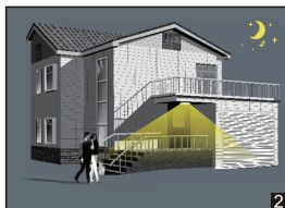
Bewegung erfasst, der Sensor schaltet die Lampe ein.
